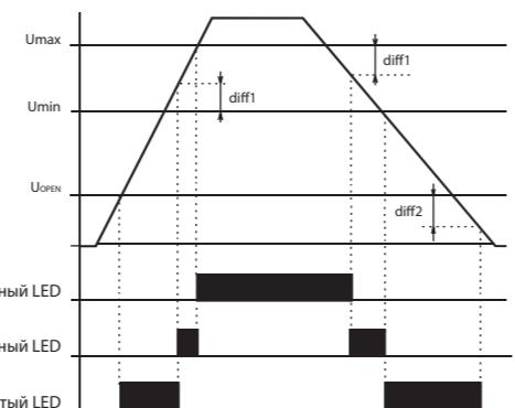
При подключении питания загораются LED диоды - их цвет соответствует величине напряжения на отдельных фазах. Если фазовое напряжение упадет ниже 40V (выпадение фазы), соответствующий LED погаснет.
