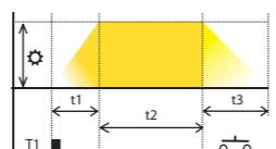
Нажатием кнопки начнется цикл нарастание - свечение - убывание. Возможна продление времени цикла повторным нажатием кнопки (во время цикла).
