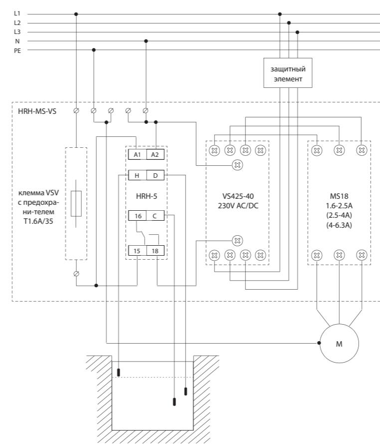
Функция слива (откачки) (DOWN) используется для защиты от переполнения и затопления помещения. При детекции максимального уровня 1 или 3-фазный насос начнет откачивать воду до достижения минимального уровня. После этого насос отключится и перейдет в режим ожидания.
