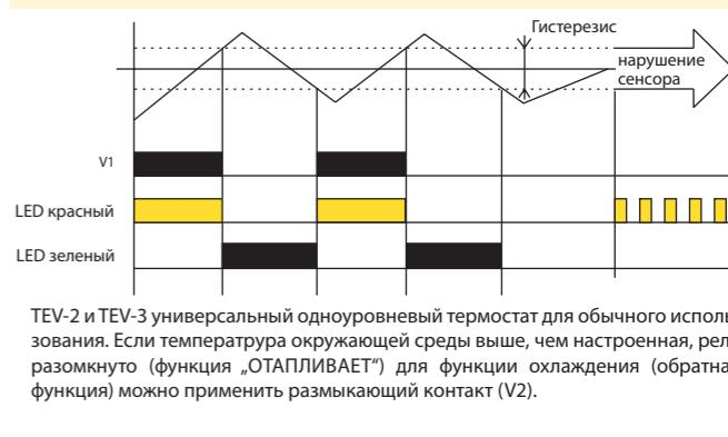
TEV-2 и TEV-3 универсальный одноуровневый термостат для обычного использования. Если температура окружающей среды выше, чем настроенная, реле разомкнуто (функция „ОТАПЛИВАЕТ“) для функции охлаждения ( обратная функция ) можно применить размыкающий контакт (V2).
