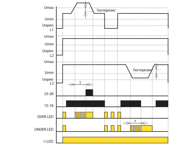
Когда контролируемое напряжение питания подключено, зеленый светодиод горит. Если контролируемое напряжение меньше установленного уровня Umin, красный светодиод OVER не горит. Реле OVER (контакты 15-16-18 и 25-26-28) разомкнуто.
