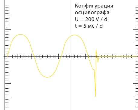
Процесс выключения контактора с катушкой на 230 V / AC и R-C компонентом 390 Ohm 330-nF
