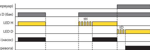
Реле предназначено для контроля уровня проводящих жидкостей с возможностью выбора из 8 функций:
