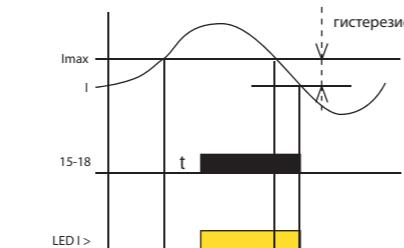
Реле PRI-52 служит для контроля силы тока в однофазовых АС цепях. Плавная настройка обеспечивающего тока предназначает реле для многих и разных электроинсталляций. Реле выхода в нормальном состоянии выключено. При превышении заданного уровня тока реле после настроенной задержки замкнет. При возвращении из состояния ошибки в нормальное состояние проявляется гистерезис.
