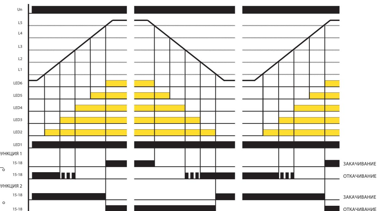
Устройство предназначено для контроля за уровнем токопроводящей жидкости в баках при помощи шести простых зондов или одного шестикратного зонда. В случае использования токопроводящего бака возможно использовать бак вместо одного совместного зонда C.
