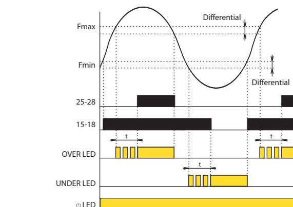
После подключения питания (контролирует напряжения) горит зелёный LED. Если величина контролируемой частоты находится в пределах Fmin - Fmax, не горит никакой красный LED. Замкнутое реле OVER (контакты 25-26-28) и разомкнутое реле OVER (контакты 15-16-18) в течение задержки мигает красный LED.
