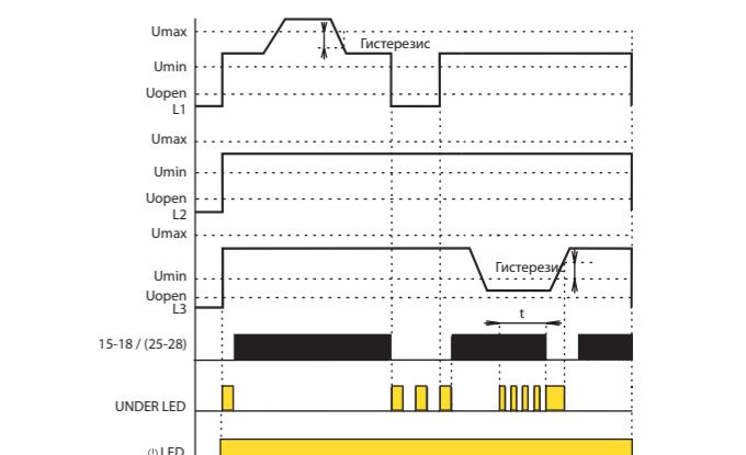
Когда контролируемое напряжение питания подключено, зеленый светодиод горит. LED. Если контролируемое напряжение находится между установленными уровнями Umin - Umax, красный светодиод не горит. Реле UNDER (контакты 15-16-18) замкнуто, а реле OVER (контакты 25-26-28) разомкнуто.
