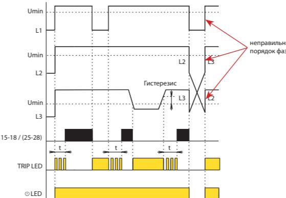
Когда контролируемое напряжение питания подключено, зеленый светодиод горит. Если последовательность фаз правильная и в то же время контролируемое напряжение выше, чем уровень Umin, красный светодиод TRIP не горит и реле замкнуто (в 1-модульном контакте 15-16-18, в 3-модульном контакте 15-16-18 и 25-26-28).
