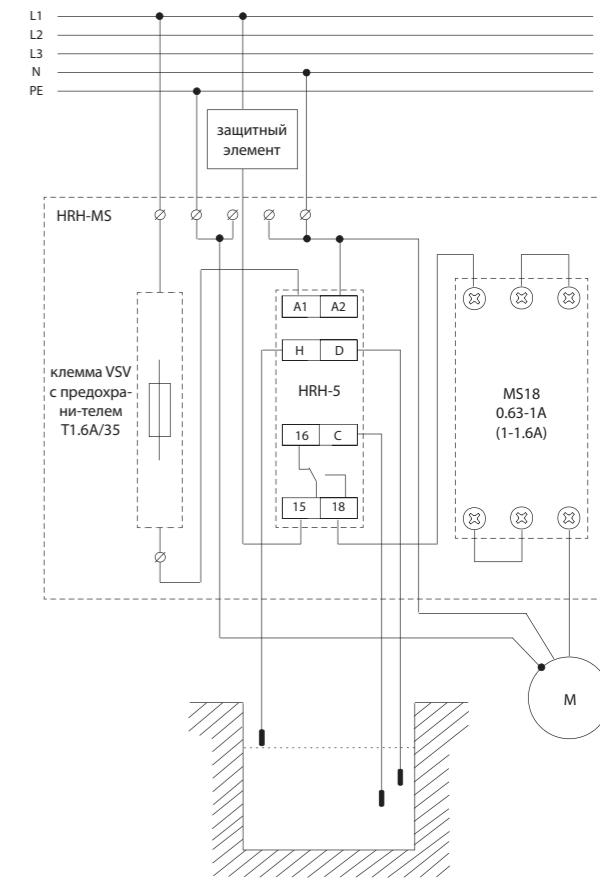
Комплекс контроля уровня жидкости HRH-MS-VS-2.5A (HRH-MS-VS-4A, HRH-MS-VS-6.3A)
