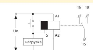
Можно подключить нагрузку между S-A2 (к примеру контактор, диммер и др.), без влияния на функционирование реле. (нагрузка под напряжением при состоянии ВКЛ.).
