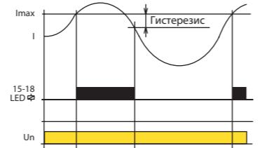
Реле контроля PRI-32 предназначено для контроля уровня токов в однофазных АС цепях. Плавная настройка подаваемого тока позволяет использовать реле в аппликациях с необходимостью индикации проходящего тока, используется также как реле выбора. Выходное реле в нормальном состоянии разомкнуто. При превышении настроенного уровня силы тока реле замыкается. Выгодой в данном случае является универсальное напряжение питания.
