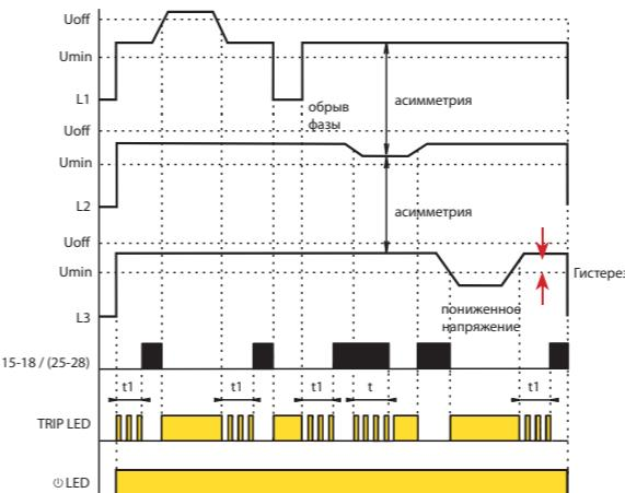
Когда контролируемое напряжение питания подключено, зеленый светодиод горит. Если фазовая асимметрия контролируемого напряжения меньше установленного уровня Unbalance, красный светодиод TRIP не горит, а реле замкнуто в 1-модульном контакте 15-16-18, в 3-модульном контакте 15-16-18 и 25-26-28.
