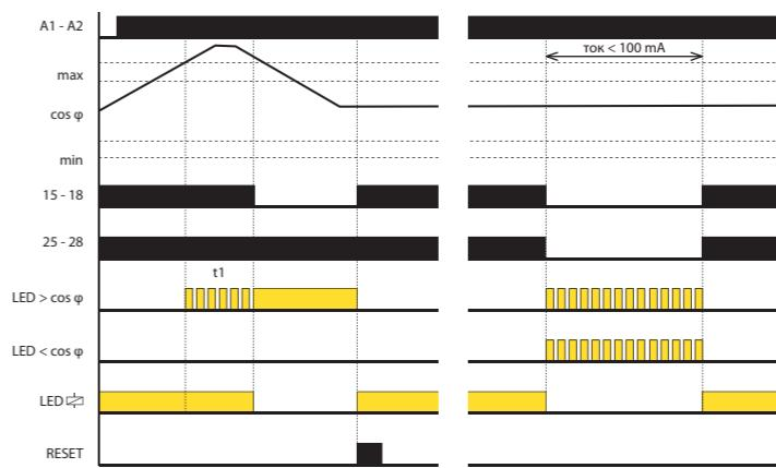
При включении питания начинается отсчет времени задержки включения t1 и мигает желтый LED. Оба реле включены. Задержка используется для устранения неисправностей во время запуска двигателя. По истечении времени t1 активируется контроль COS φ.
