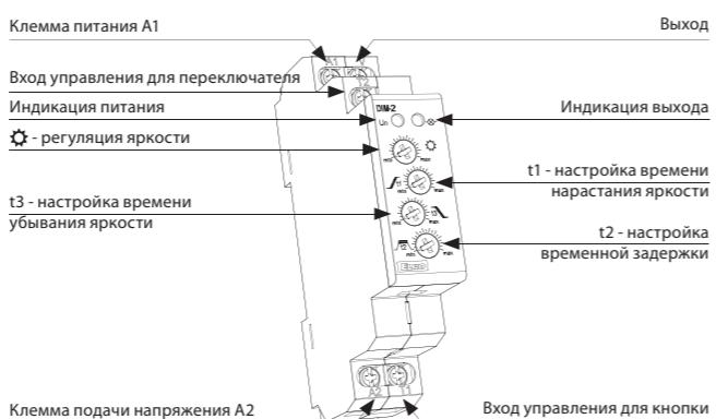
Рекомендации при установке: с каждой стороны устройства необходимо оставить пространство мин. 0.5 ширины модуля, т.е. 9 мм для лучшего охлаждения.
