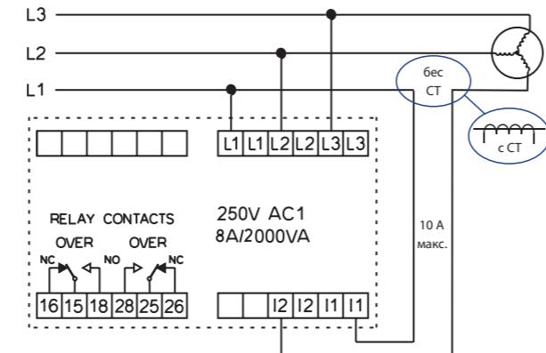
СТ - токовый преобразовательный трансформатор
