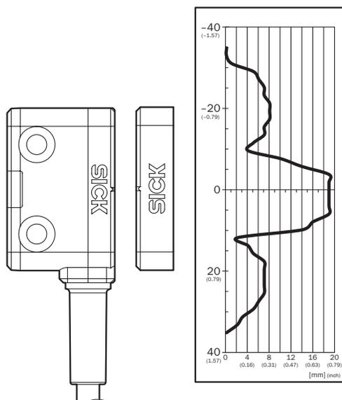
Безопасное расстояние включения  $S_{a0}$  14 мм. При параллельном приближении следует учитывать краевые зоны: если пускатель перемещается к поверхности датчика сбоку, то должно выдерживаться минимальное расстояние 10 мм. Это необходимо для предотвращения преждевременного срабатывания устройства.
