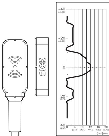
Безопасное расстояние включения  $S_{a0}$  9 мм. При параллельном приближении следует учитывать краевые зоны: если пускатель перемещается к поверхности датчика сбоку, то должно выдерживаться минимальное расстояние 4 мм. Это необходимо для предотвращения преждевременного срабатывания устройства.
