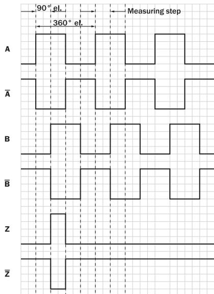
По часовой стрелке, если смотреть на вал энкодера в направлении «А», ср. габаритный чертеж.
