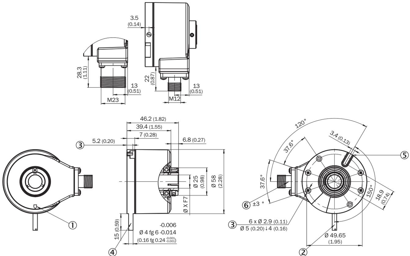
Значения XF7 см. в таблице Диаметр вала, тип сквозной полый вал, зажим сзади
